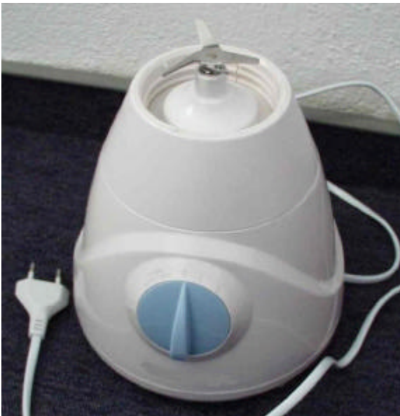
Abb.4 Standmixer ließ sich einschalten, obwohl das Messer frei zugänglich war
