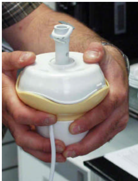
Abb.5 Zerkleinerer konnte falsch zusammengebaut und eingeschaltete werden
