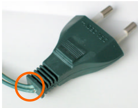
Abb.2: angebrochene Isolierung hinter der Steckvorrichtung
