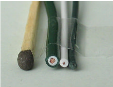
Abb. 1: Leitungsquerschnitte im Vergleich (v.l.n.r.), links Streichholz, dann korrekter Leitungstyp, daneben einfache Isolierungen, unzureichender
