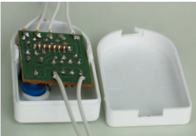
Abb.3 geöffnete Blinkeinrichtungen, Leitungen sind auf der Platine nur angelötet (ohne wirksame Zugentlastung)
