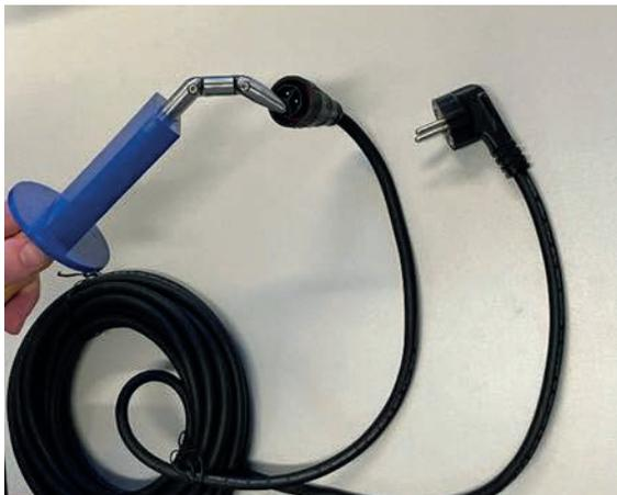
*Bild 8: Prüfung mit dem Norm-Prüffinger – Foto: Christian Müller*
